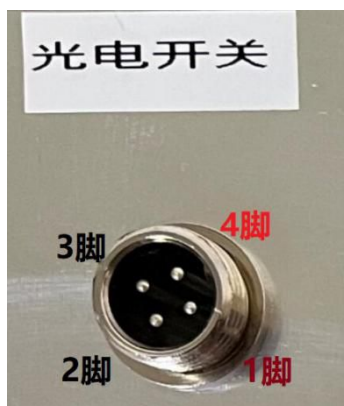
图 4.3.2 后盖光电开关引脚示意图
