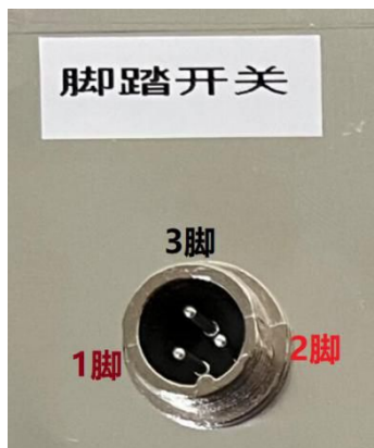
图 4.3.1 后盖脚踏开关引脚示意图
